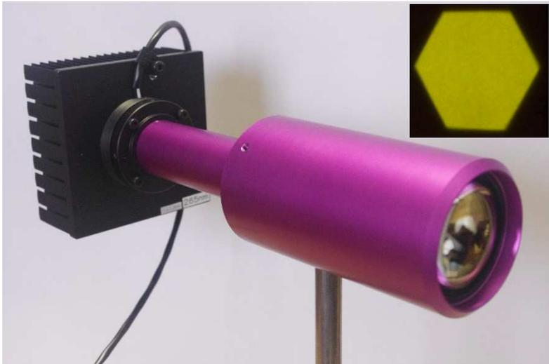
画期的な装置です。除菌・殺菌用途はもちろんのこと、各種ライフサイエンス分野や検査・接着等の工業分野にも使っていただける装置になっています。しかも、照射面のどこにおいても中心部と同じ照射条件で照明できる「テレセントリック光学系」を採用しています。
